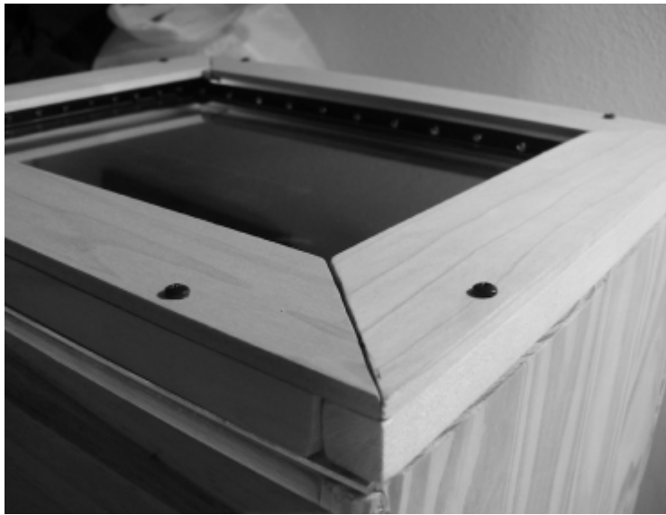
图 1.7.1 发光二极管平面多点触摸技术（LED-LP）装置
